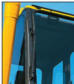
Стеклоочиститель, смонтированный на раме кабины
